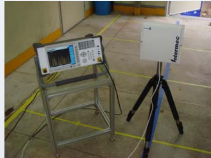
<RFID 전파출력 측정 장치(스펙트럼) 및 시작기>
