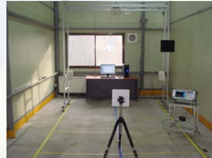
<RFID 전파출력 측정 장치(스펙트럼) 및 시작기>
